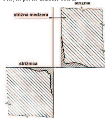
Obr. 2. Tvar opotrebovaných strižných plôch
