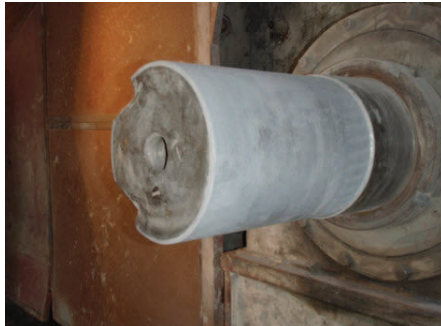
obr. č. 1 Hriadeľ (priemer 270 mm, dĺžka opravovanej plochy 370 mm) pohonu remenice (hmotnosť 4 tony) po oprave nanesením plastického kovu a opracovaním na mieste
