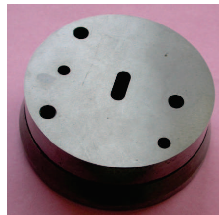
Obr. 6 Strižnica po správnom preostrení
