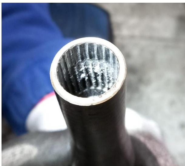
Obr. 1 Poškodené ozubenie hriadeľa
