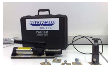
Obr. Merací prístroj na meranie adhézie so vzorkami
