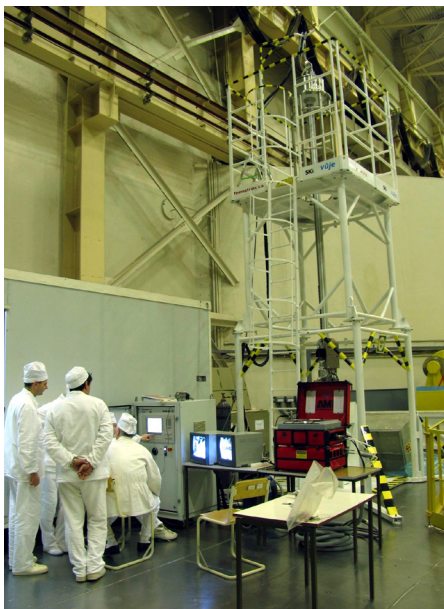
Manipulátor ZOK - zaslepovanie teplovýmenných rúrok na Kolskej JE
