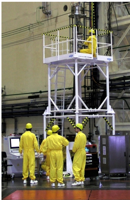
Manipulátor ZOK PG-07 - príprava na prevádzkovú kontrolu v JE Dukovany
