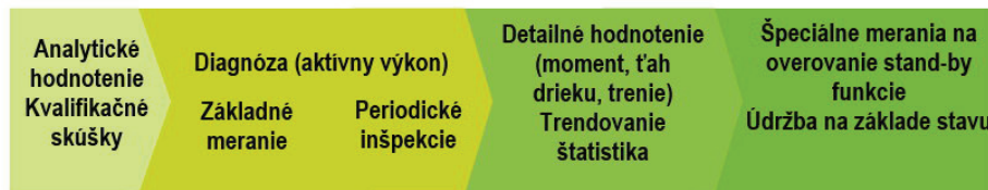
Obr. 3 Koncepcia diagnostiky ventilov a pohonov ADAM/SIPLUG
