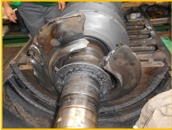
Obr. č. 8: Zaznamenané poškodenia na komponentoch kompresora
