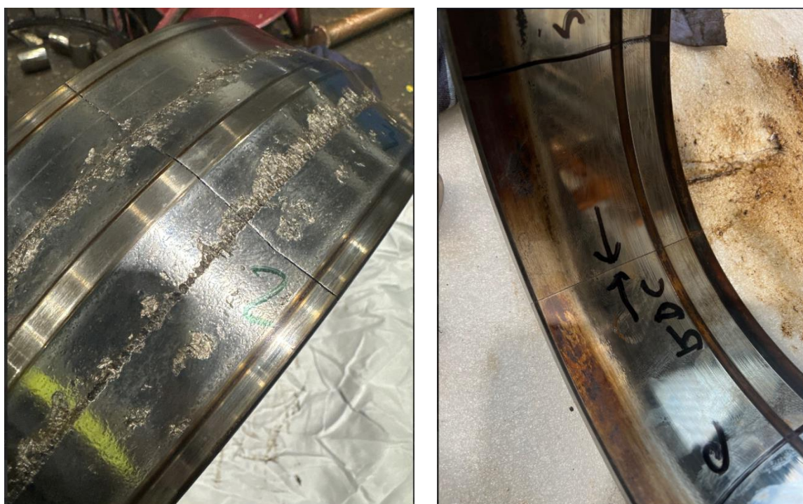
Obr.7 Poškození vnitřního kroužku ložiska (příčná prasklina kroužku)
