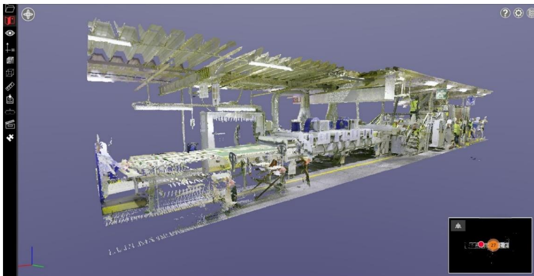
Obr. 4 Náhľad na spracované mračno bodov výrobnjej linky
