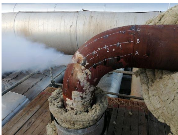
Obr. 13 Meranie korózie urýchlenej prúdením (FAC)
