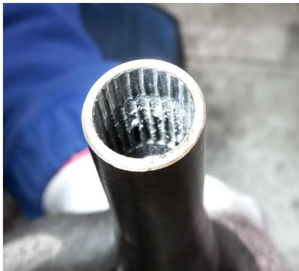
Obr. 1 Poškodené ozubenie hriadeľa
