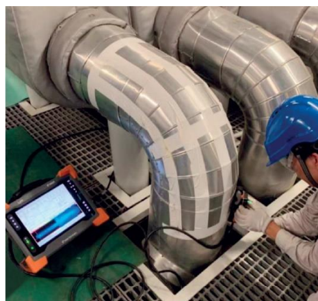
Obr. 13 Meranie korózie urýchlenej prúdením (FAC)
