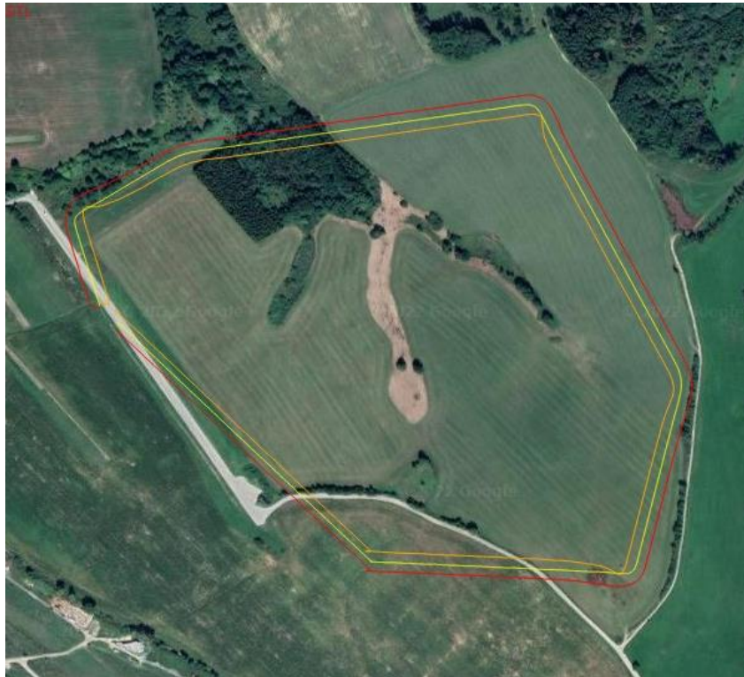
Obr. 5 Ukážka trajektórií letu formácie v tvare šípky troch UAV
