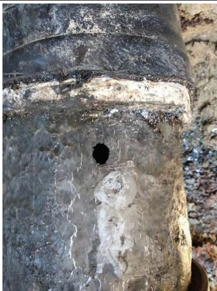
Obr. 7 Potrubie poškodené jamkovou koróziou
