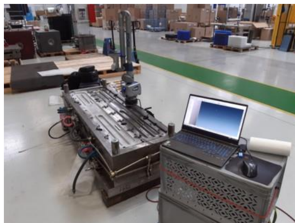
Obr. 6 Meracie rameno pri nastavovaní formovačky drôtu (vľavo), meracie rameno – skenovanie vstrekovacej formy (vpravo)
