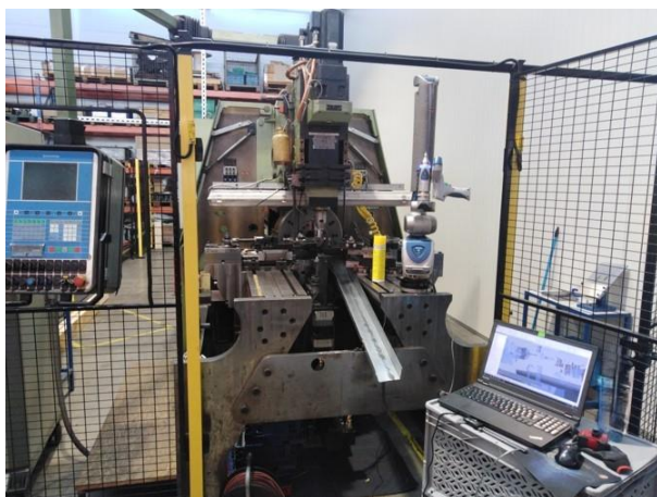
Obr. 6 Meracie rameno pri nastavovaní formovačky drôtu (vľavo), meracie rameno – skenovanie vstrekovacej formy (vpravo)
